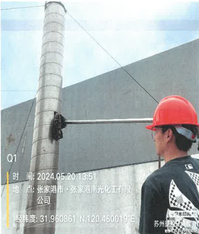
采样点位: DA001 布袋除尘废气排放口 Q1
